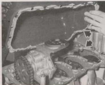
Montage du carter inférieur, enduire les plans de joint de pâte.
