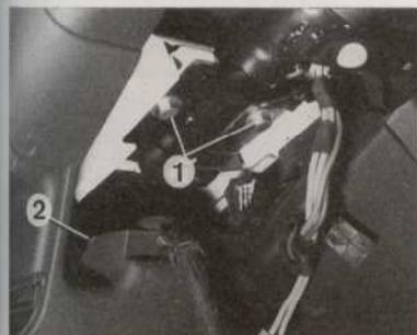
**Dépose de la colonne de direction**
