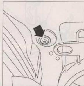
Dépose de la vis de fixation inférieure du radiateur de refroidissement.
