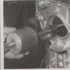
Extraction de la bague d'étanchéité côté distribution.
