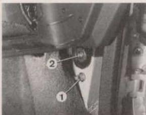
1. Déposer le câble de masse - 2. Vis de fixation latérale de la planche de bord.
