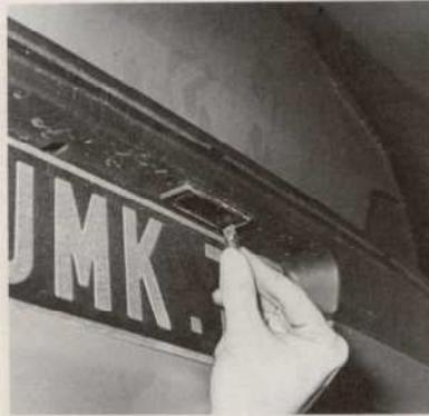
Remplacement de la lampe d'éclairage de la plaque minéralogique. (Photo RTA).
