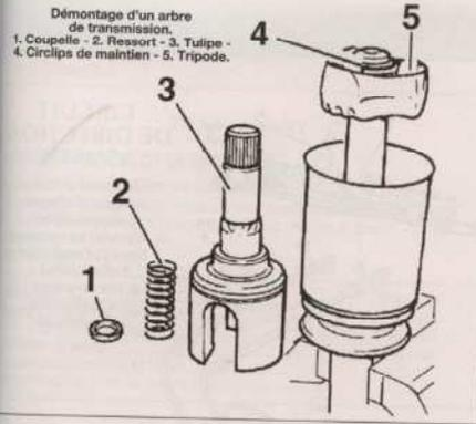
Démontage d'un arbre de transmission.
