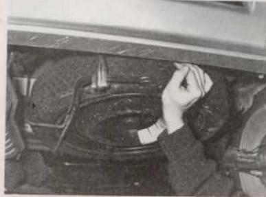
Dégagement du crochet de retenue du panier de roue de secours. (Photo RTA).
