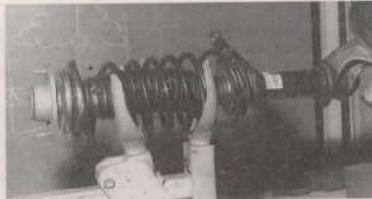
Jambe de suspension en place sur le compresseur de ressort.
