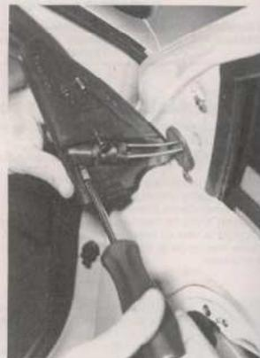
1. Vis de fixation de la garniture de rétroviseur sur le mécanisme.
