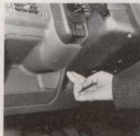
Levier de déverrouillage du capot. (Photo RTA).
