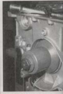
Repose de la bague d'étanchéité de distribution.
