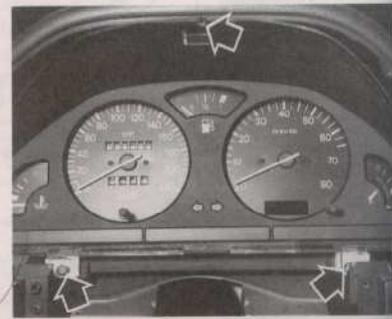
Vis de fixation du combiné d'instruments.
