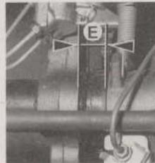
Repose du bras de suspension. Respecter l'écartement E = 23 mm pour un travail correct de la bague d'étanchéité sur la rondelle d'appui.
