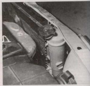
Orifice de remplissage du radiateur du circuit de refroidissement (Photo RTA).
