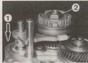
Dépose de l'écrou d'arbre secondaire
