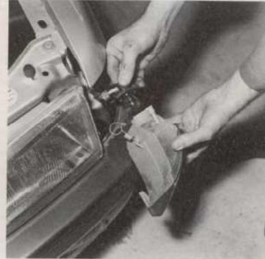
Remplacement d'une lampe de clignotant. (Photo RTA).
