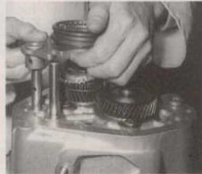
Dépose du synchroniseur de 5<sup>e</sup> avec sa fourchette.
