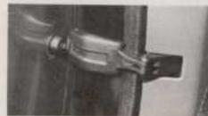
Levier d'entrebâillement d'une vitre latérale arrière. (Photo RTA).
