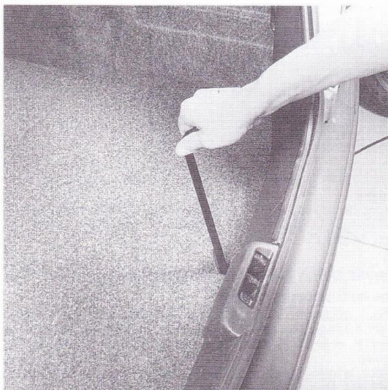
Débloquage de l'écrou pour dégager le panier de roue de secours
