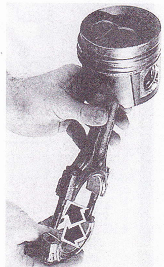
Assemblage bielle-piston. Flèche : orientation des ergots de positionnement.
