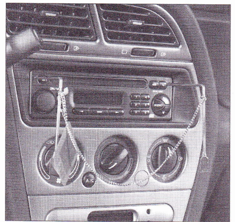
Dépose de l'autoradio avec l'outil approprié.
