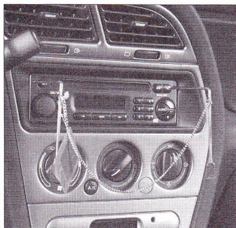
Dépose de l'autoradio avec l'outil approprié.
